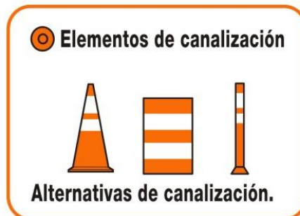
FIGURA 22: ELEMENTOS DE CANALIZACION
